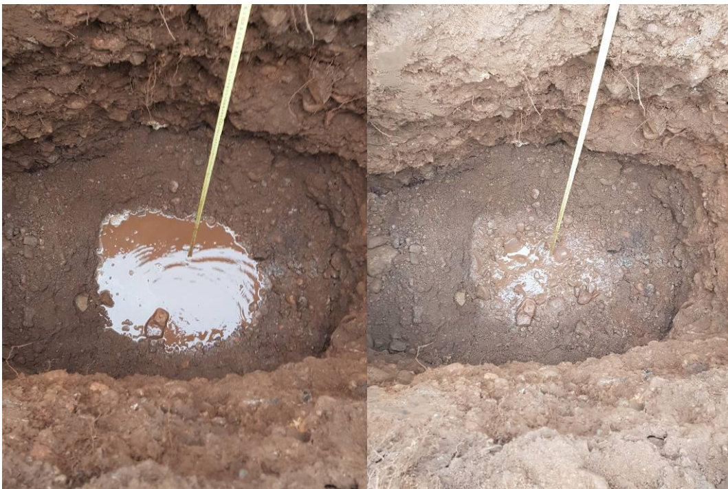
Foto 20 e 21: Inizio e fine prova infiltrometrica in scavo S4
