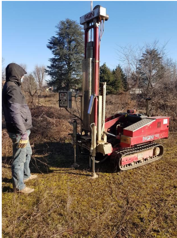
Foto 6: Posizionamento ed esecuzione prova DP 3
