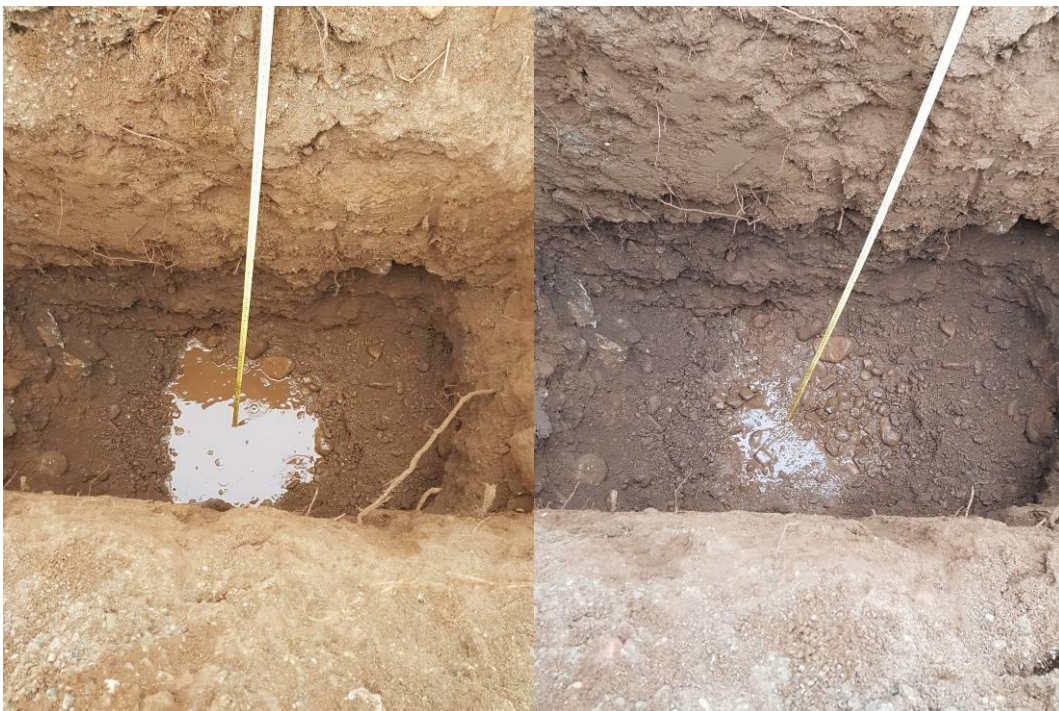
Foto 16 e 17: Inizio e fine prova infiltrometrica in scavo S2
