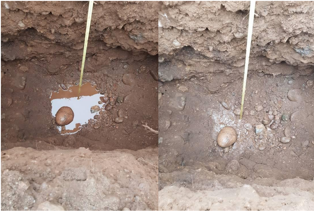
Foto 18 e 19: Inizio e fine prova infiltrometrica in scavo S3
