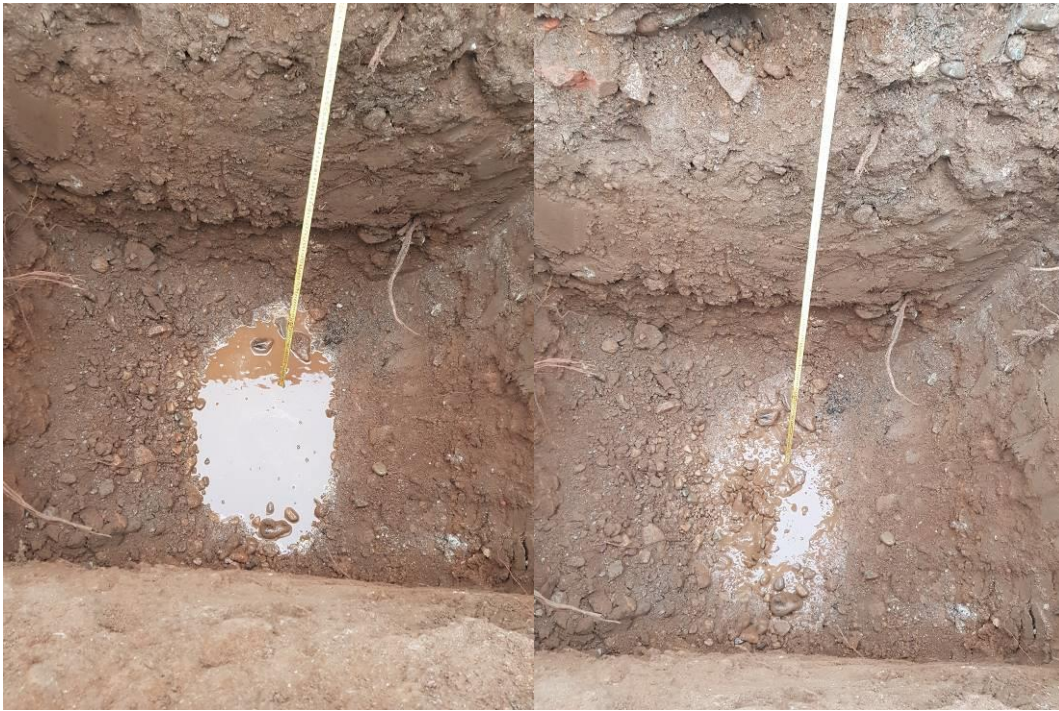
Foto 14 e 15: Inizio e fine prova infiltrometrica in scavo S1
