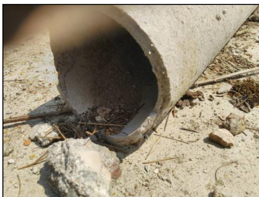
Elementi in cemento amianto rilevati nei cumuli in oggetto, tutti riconducibili a frammenti di condotte.
