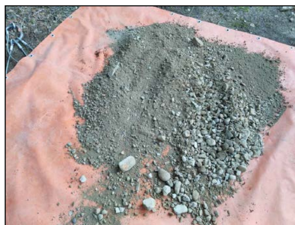
A sinistra, deposizione del campione omogeneo dell'ultima quartatura setaccio a 2cm, a destra, il sovrallo a 2cm residuo
