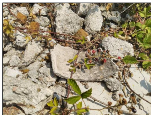
Elementi in cemento amianto rilevati nei cumuli in oggetto, tutti riconducibili a frammenti di condotte.
