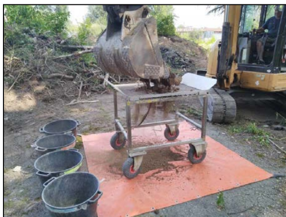
A sinistra, deposizione del campione omogeneo dell'ultima quartatura setaccio a 2cm, a destra, il sovrallo a 2cm residuo
