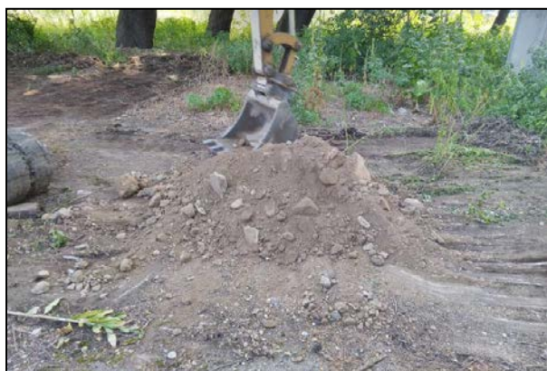
Fasi di riduzione del campione omogeneo per quartature successive
