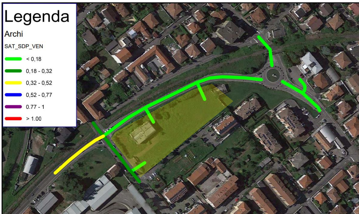
Figura 25 - Scenario SDP della sera del venerdì. Flussogramma flusso/capacità della rete dell'area di studio
